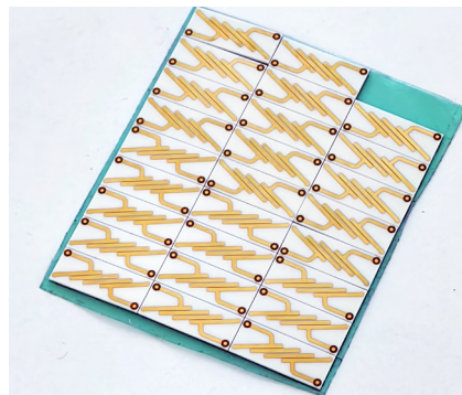
Рис. 2. Групповая заготовка с фильтрами с контактами типа flip-chip
